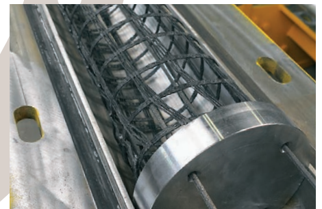
Armature d'un mât d'éclairage Carbolith® d'une longueur de 4,2 mètres.
